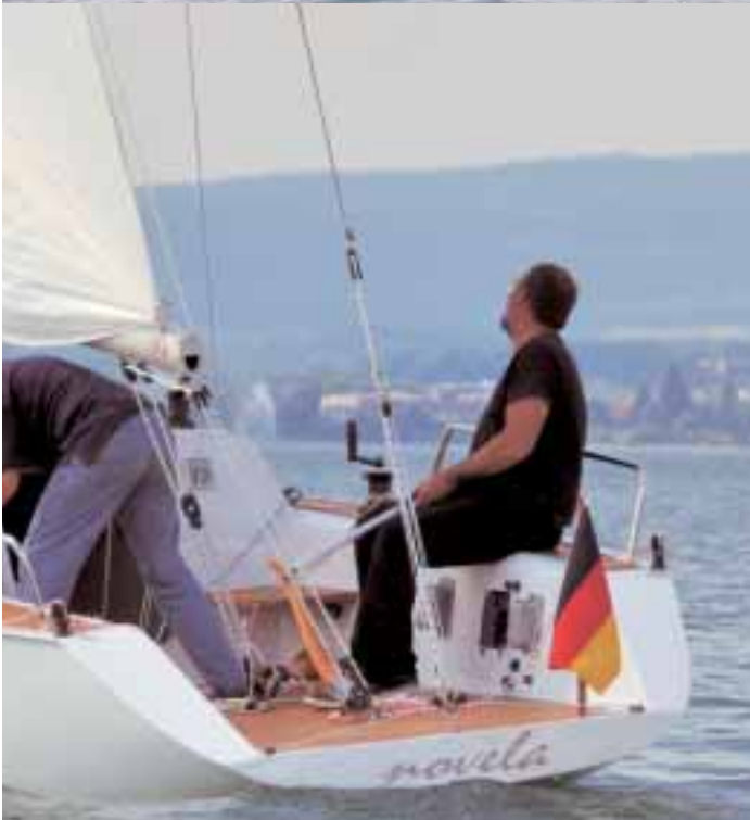
alistische, solide Technik zeichnet die Abraxas aus. Allerdings lässt sich oßbaum nicht mittschiffs holen, ohne dass das Achterliek zu sehr Bt. Eine Hahnepot wäre hier wünschenswert.
